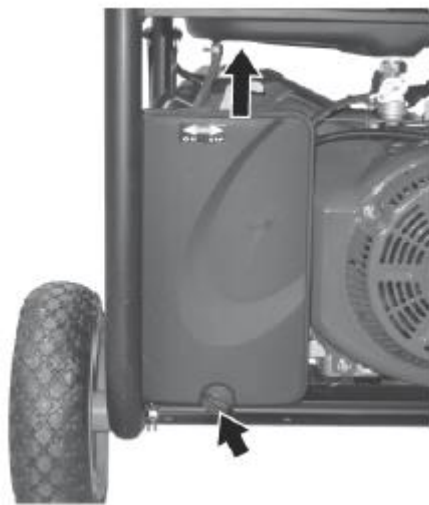
Демонтаж на капака на въздушния филтър
